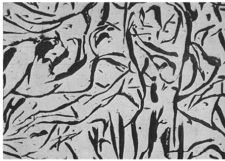
Graues Gusseisen mit Lamellengraphit, ungeätzt
